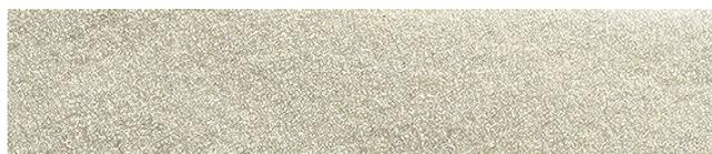
Edelkorund EK weiss gehört zu der Gruppe der Elektrokorunde. Er wird durch Schmelzen von Spezial-Tonerde im elektrischen Lichtbogenofen nach dem Blockverfahren hergestellt, ist von höchster Reinheit, extrem hart, spröde und hat nahezu den Schmelzpunkt des reinen Aluminiumoxids. Ein eisenfreies Feinstrahlmittel für allerhöchste Ansprüche.
