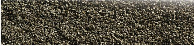
Das Hartguss-Strahlmittel gehört zur Gruppe der gegossenen, metallischen Strahlmittel. Es wird aus einer geeigneten schmelzflüssigen Hartguss-Legierung granuliert und mechanisch in Korngrößen nach DIN 8201 Teil 2 und Teil 3 aufbereitet. Die Herstellung unterliegt strengen Fertigungskontrollen hinsichtlich Kornform, Korngrösse, mechanische und metallurgische Eigenschaften.
