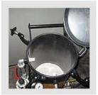
In jeder Hinsicht eine glänzende Figur: Das lackierte Kesselinnere lässt das Granulat gleiten und schützt vor Korrosion.
