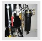
Effizienter Wirbelwind: Der wartungsfreie Wasserabscheider entzieht dem Kondensat bis zu 99 % Feuchtigkeit.
