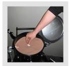
Tiefe Einblicke in den Kessel: Der Strahler kann jederzeit den Füllstand kontrollieren oder Fremdkörper entfernen.
